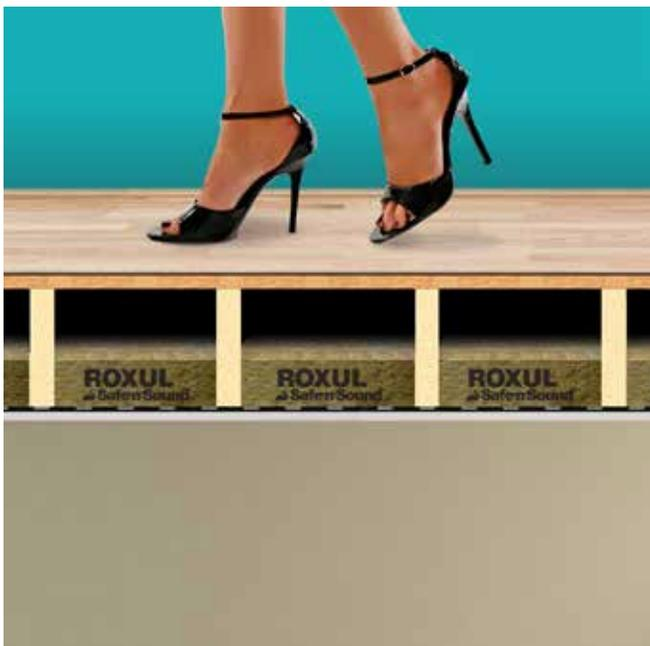
Un **bruit aérien**, par contre, est un son provenant de l'extérieur (avions, automobiles, tondeuses à gazon) ou de l'intérieur (conversations, musique, appareils électroménagers). L'ajout de matériaux d'atténuation sonore (comme l'isolant SAFE'N'SOUND) et un espace d'air dans les cloisons et les plafonds peuvent réduire la transmission de bruits aériens.
