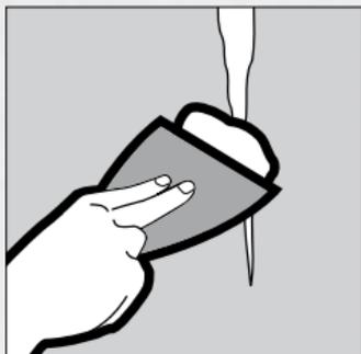
d. Appliquer le composé sur le ruban avec une spatule. Laisser durcir, puis appliquer une deuxième couche de composé au besoin. Laisser sécher, puis poncer et appliquer un apprêt.
