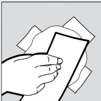
c. Croiser deux ou trois bandes de ruban à joints sur l'ouverture et noyer le ruban dans du composé à joints. Laisser durcir.
